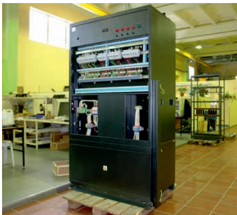
ТФ-Т-40-35-Б — трансфильтр трехфазный мощностью 40 кВА, имеет на выходе 35 направлений
