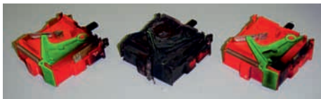
Поврежденные блочные варисторы DEHN
